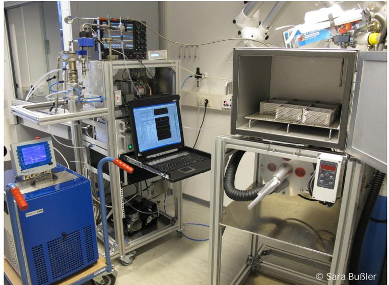
Abbildung 1: PlexC Plasmaanlage (INP Greifswald) zur Erzeugung von plasmaprozessierter Luft mit Behandlungskammer (rechts).
