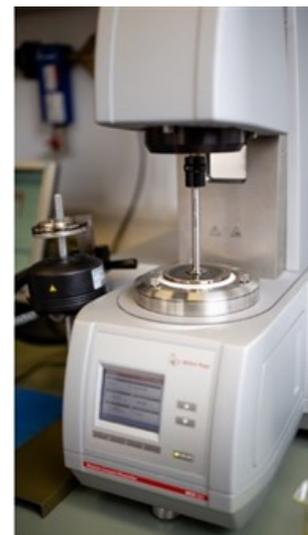
Abb. 2: Das Rheometer zur Messung der Fließeigenschaften der Joghurtvarianten.
